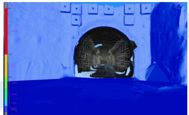
Analyse 3D du gabarit d'un camion dans le passage d'une galerie.
